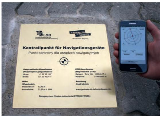
Abb. 1: Bodenplatte des Kontrollpunktes
