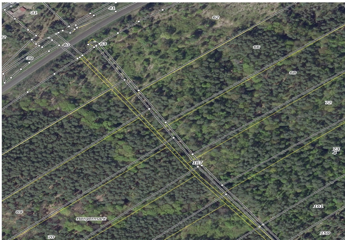
Abbildung 4: Beispiel Potsdam-Mittelmark, Belzig - Fehlerbehebung im Projekt (Gelb - fehlerhafte Darstellung, Schwarz - nach Korrektur)
